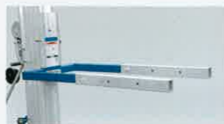
フォークエクステンション 標準フォークに挿入する延長アーム。水平リーチ を64cm増。
